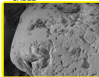
Illustration des micro-cavités sur un grain de sable (TEN 0.8)
