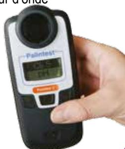
Chlore libre et total, pH, Acide cyanurique (stabilisant), Brome, TAC (alcalinité), TH calcique (dureté calcaire)
