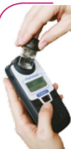
Chlore libre et total, pH, Acide cyanurique (stabilisant), Brome, TAC (alcalinité), Fer, TH calcique (dureté calcaire), Cuivre libre et total, Ozone
