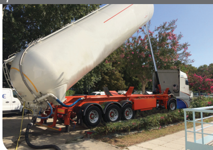
Opération de livraison vrac en cours par pulsage
